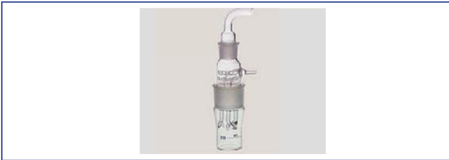
شکل ۲۱- بیوسمپلر مورد استفاده برای نمونه برداری بیوائروسول (حاوی سه جت ایجاد کننده برخورد در سطح مایع)
